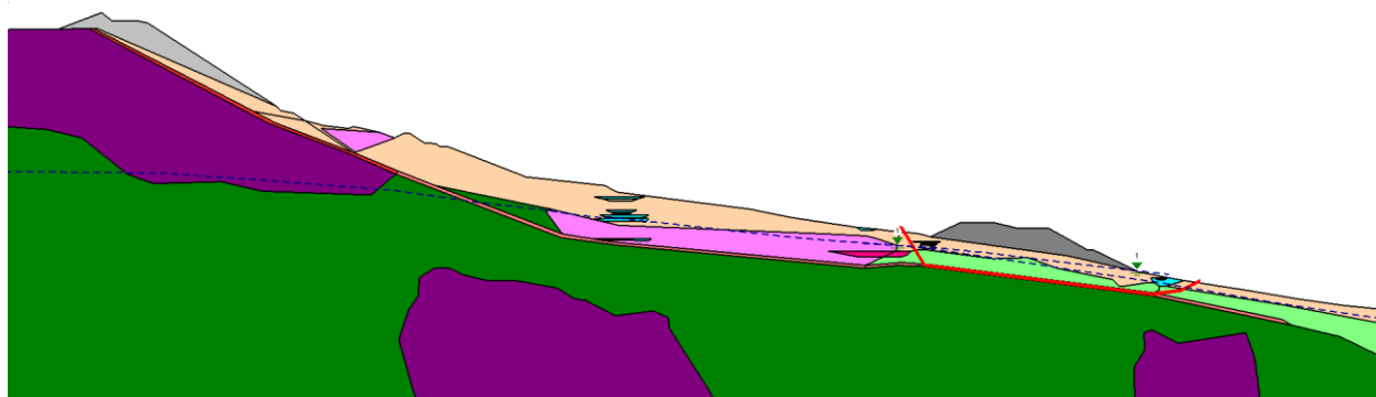
Obrázek 46. Profil 2, smyková plocha pouze pod násypem.
