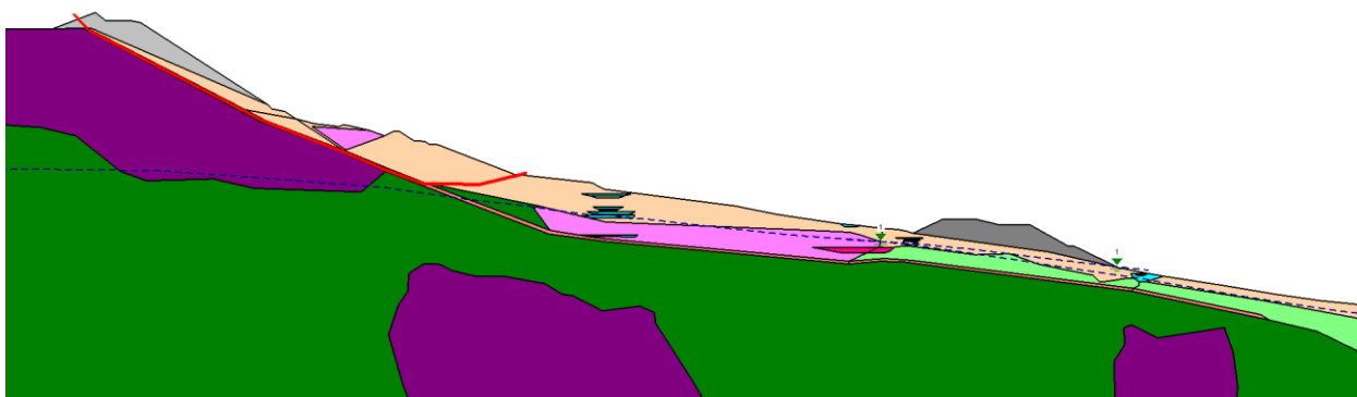
Obrázek 44. Profil 2, smyk. plocha pouze výsypka.
